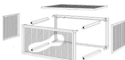
Elle permet une protection discrète et esthétique des unités extérieures contre le vandalisme et le vol. Le cadre est en aluminium peint. Les panneaux de protection sont en toile acier galvanisé perforé.
